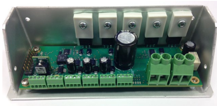
图 4: 莱尔德热系统的 SR-54 系列温度控制器。
